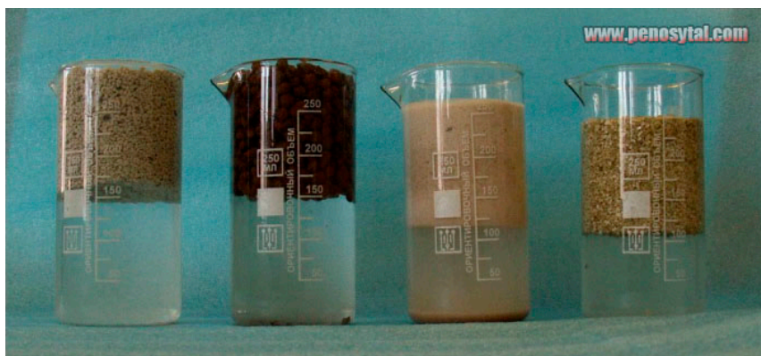
Рис 1. Пеностекло, керамзит, перлит, вермикулит в воде
