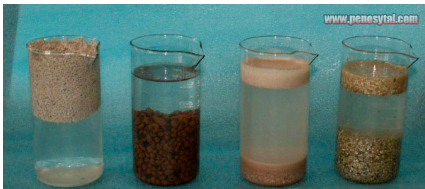
Рис 2. Пеностекло, керамзит, перлит, вермикулит в воде через 1 месяц
